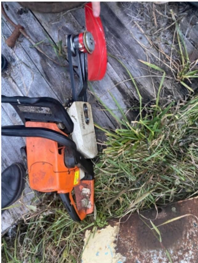
Вчера днем во дворе частного дома в деревне Усть- Вага при распиливании металломолома получил смертельную травму шеи 62-летний мужчина. По предварительным данным, при производстве работ лопнул диск у резака-приставки к бензопиле, его фрагмент на высоких оборотах отскочил и травмировал пострадавшего. По данному факту следственными органами Следственного комитета Российской Федерации по Архангельской области и Ненецкому автономному округу проводится доследственная проверка.
