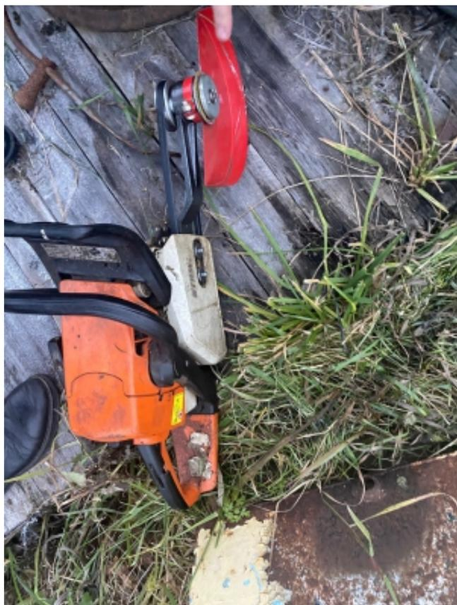
Вчера днем во дворе частного дома в деревне Усть- Вага при распиливании металлолома получил смертельную травму шеи 62-летний мужчина. По предварительным данным, при производстве работ лопнул диск у резака-приставки к бензопиле, его фрагмент на высоких оборотах отскочил и травмировал пострадавшего. По данному факту следственными органами Следственного комитета Российской Федерации по Архангельской области и Ненецкому автономному округу проводится доследственная проверка.
