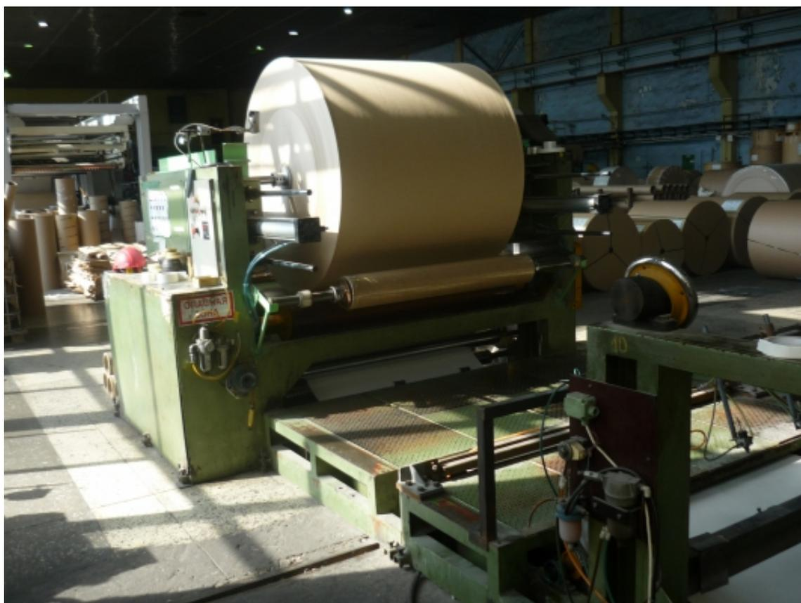
27 августа 2022 года утром при производстве работ по оборачиванию рулонов пленкой у 30-летнего оператора ламинаторной машины коммерческой организации, расположенной в городе Коряжма, произошла травматическая ампутация правой кисти руки. По предварительной информации, пострадавший в нарушение правил безопасности допустил попадание руки между валами машины.
